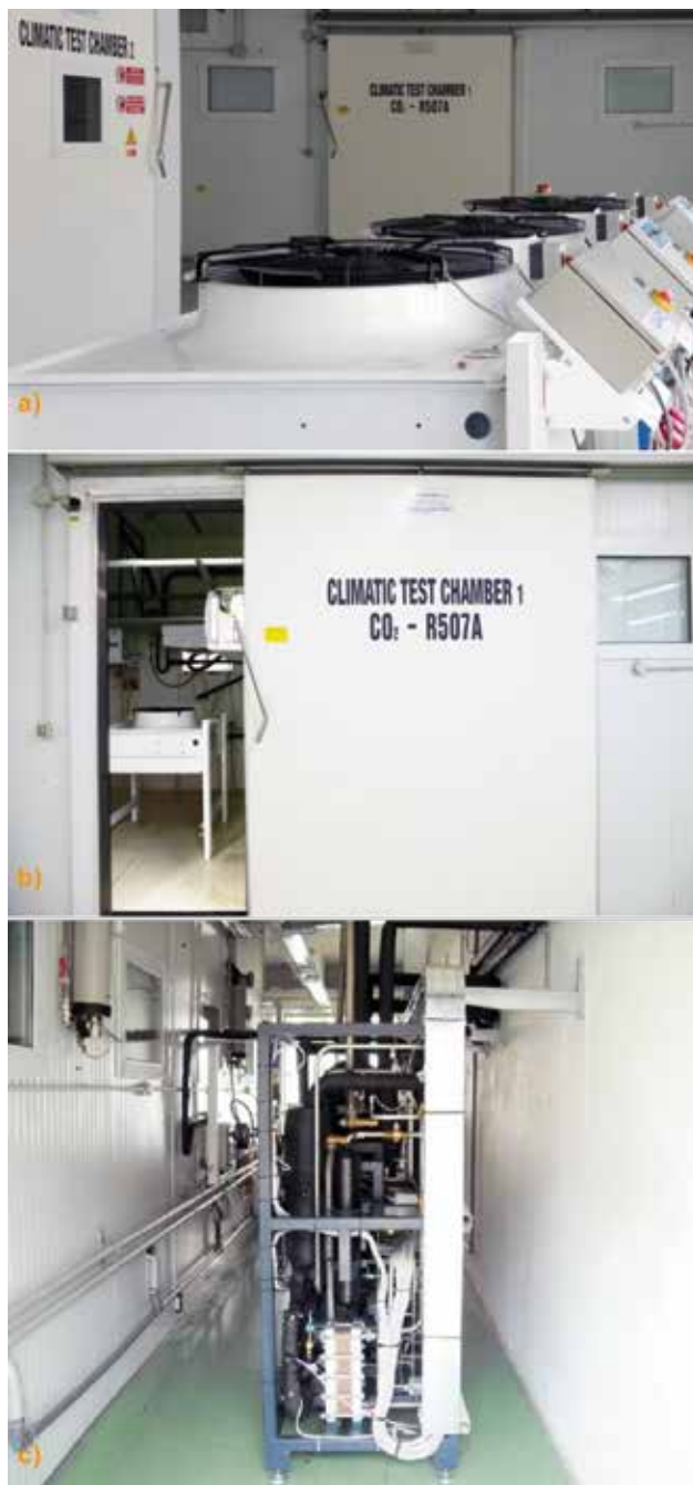
Rysunek 2: a – laboratorium testowe, b – Klimatyczna komora testowa CO 2 , c – Układy chłodnicze laboratorium testowego
