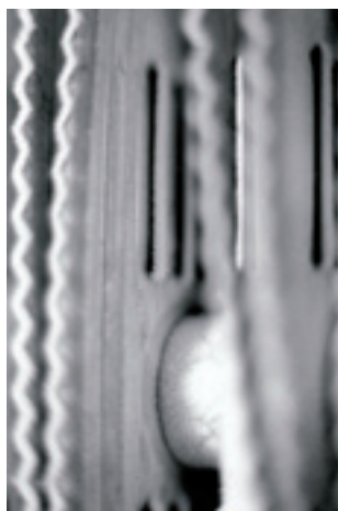
15. Lamel turbulator tijdens de berijping. Links: geen rijp, midden: tijdens het berijpen en rechts: aan het eind van de periode met veel rijp op het oppervlak.
