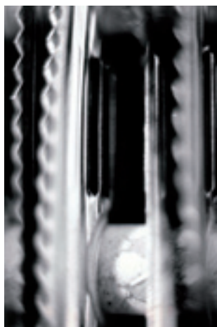
15. Lamel turbulator tijdens de berijping. Links: geen rijp, midden: tijdens het berijpen en rechts: aan het eind van de periode met veel rijp op het oppervlak.
