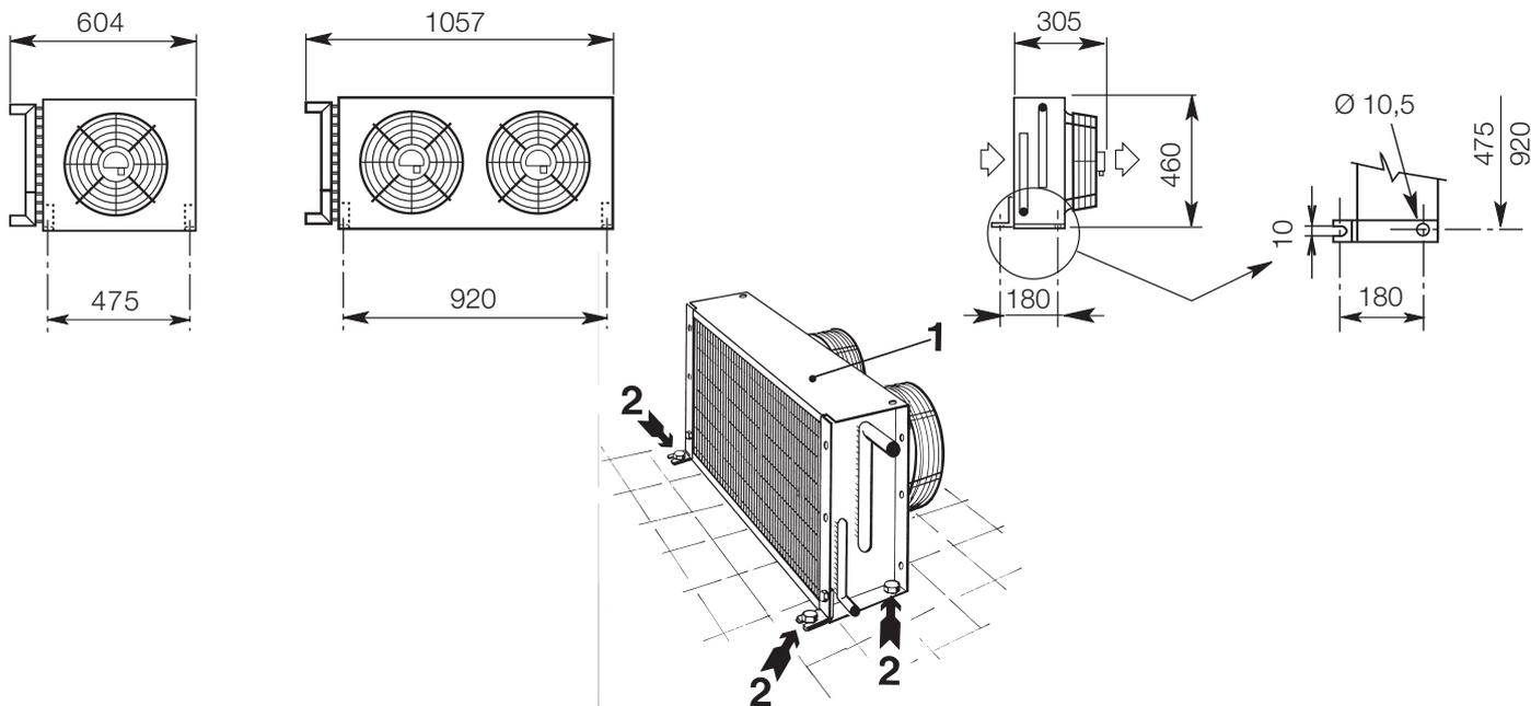
Installazione orizzontale / Horizontal installation / Installation horizontale / Aufstellung horizontal
