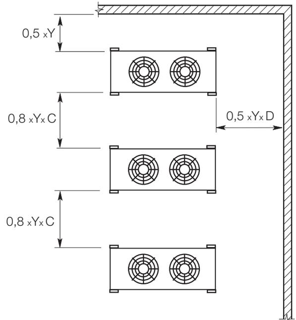
Installazione verticale / Vertical installation / Installation verticale / Aufstellung vertikal
