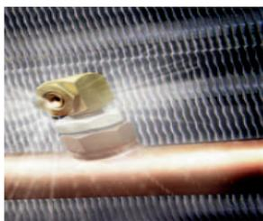
Система линий-распылителей, установленных на градирне, производит разбрызгивание воды в направлении, противоположном движению воздуха, что позволяет охлаждать сам воздух, и тем самым увеличивать мощность теплообменника.
